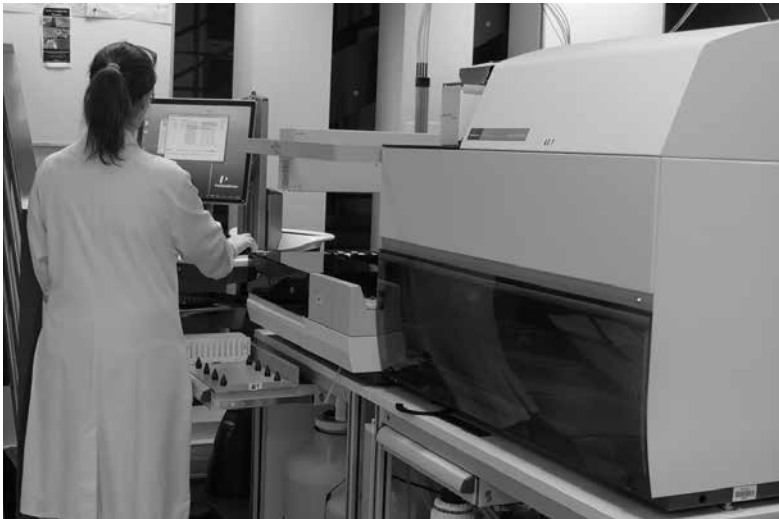
Analyseur Autodelfia pour le dosage des marqueurs sériques maternels
